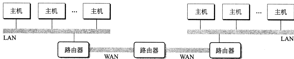
图 11-6 一个小型的互连网络。三台路由器连接起两个局域网和两个广域网
