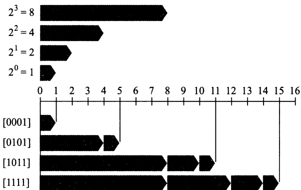
图 2-12 w=4 的无符号数示例。当二进制表示中位 i 为 1，数值就会相应加上 2^i
